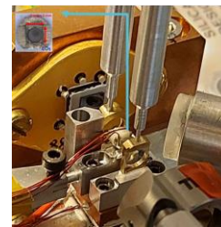
Figure 1 : Gauche : Architecture du VECSEL bifréquence bipolarisation. \frac{1}{2} -VCSEL : milieu à gain, PBS : Polarisation beam Splitter YVO 4 , EO : Cristal MgO:SLT, Etalon : filtre biréfringent YVO 4 . Droite : Photo du cœur du prototype du VECSEL.
